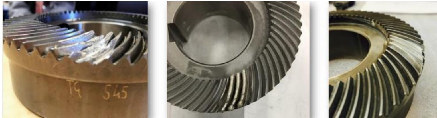
Пример восстановления изношенных зубьев колеса
